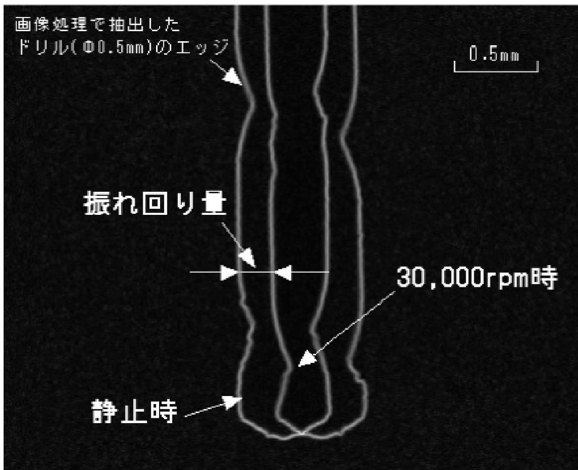
高速度カメラと画像処理による切削工具挙動量の測定
