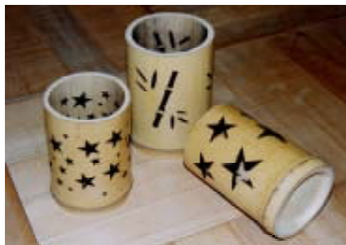
レーザーによる丸竹の透かし彫刻
