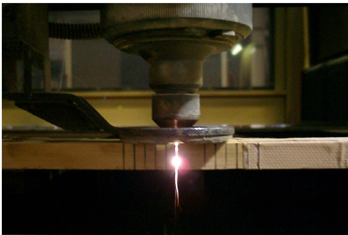
炭酸ガスレーザー加工機による木材の切断
