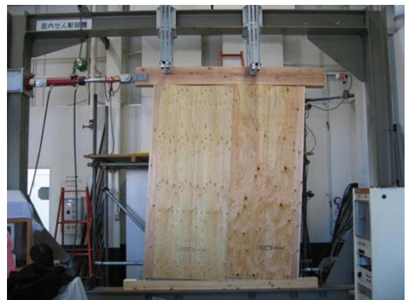
耐力壁の面内せん断試験
