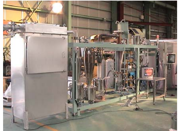
微粒シラスバルーンと粒径の異なる複数のシラスバルーンを連続的に製造する装置
