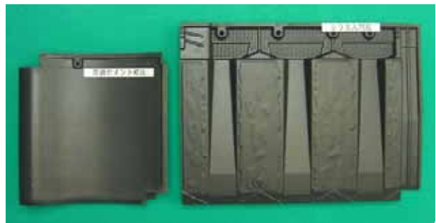
図3 普通セメント瓦(左)と軽量断熱シラス瓦(右)
