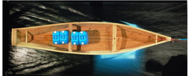
図2 ウッドカヌーの回流水槽試験
