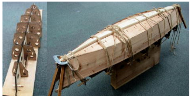
図3 型枠(左)と船体組立の様子(右)
