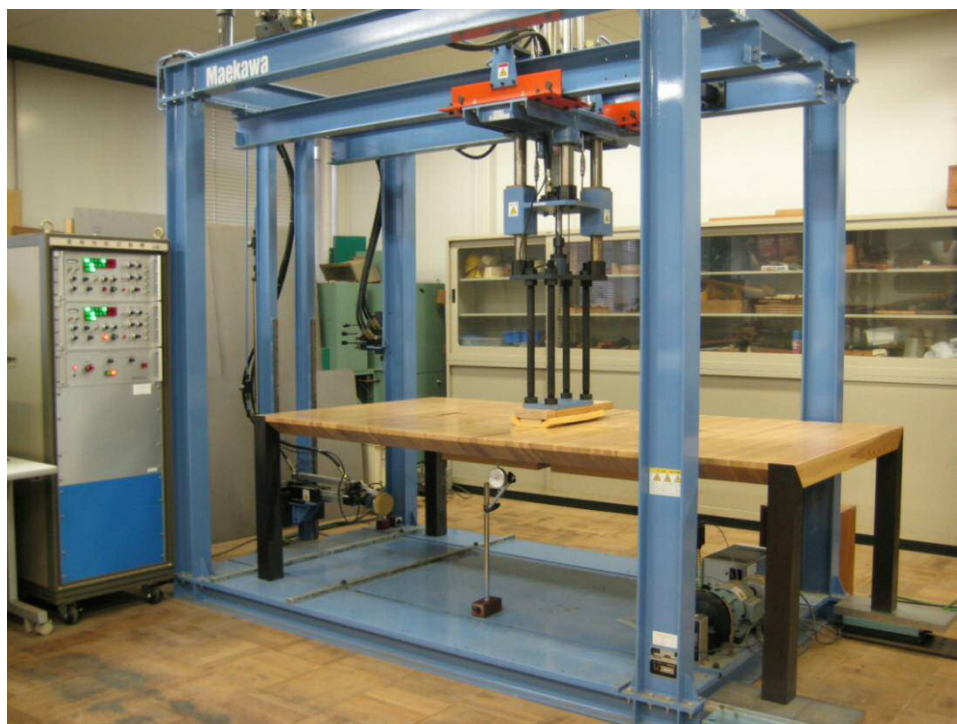
県産木材を用いたオフィス家具の性能評価試験
