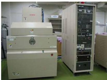
図1 スパッタリング装置
