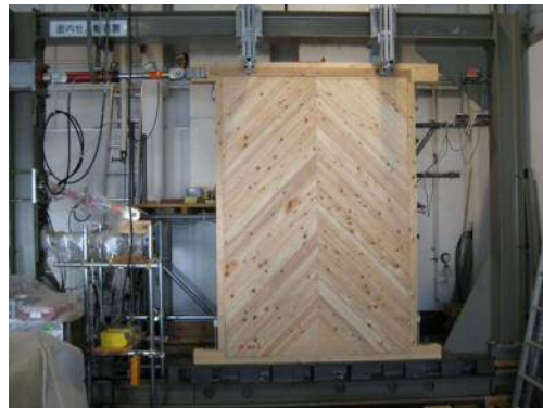
水平構面・耐力壁の面内せん断試験
