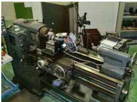
図1 旋盤を改造した実験装置
