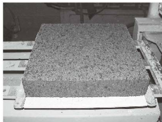
図2 電波吸収体の試作
