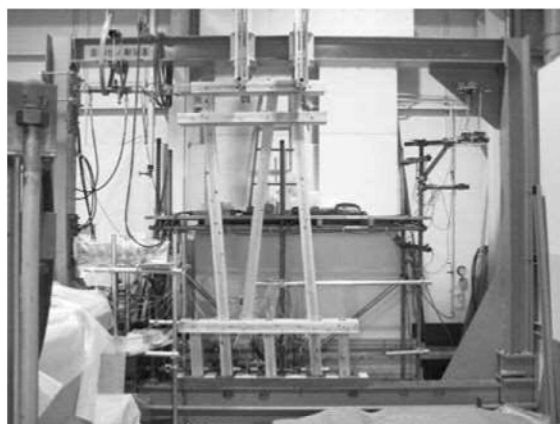
図2 軸組壁体の面内せん断試験状況
