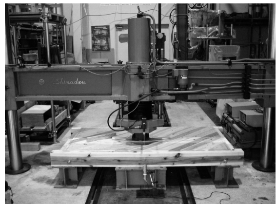
床構面の局部集中荷重試験
