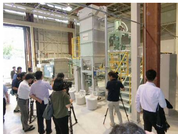
火山ガラス微粉末を製造する装置
