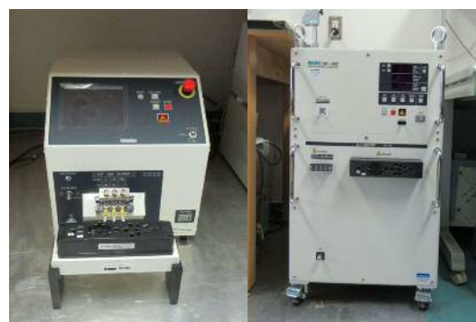
③ファスト・トランジェント/ バースト試験器 ④電源電圧変動 試験器
