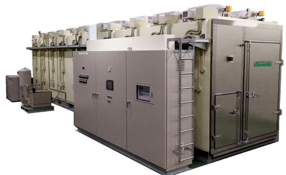
モジュール型青果物用蒸熱処理装置
