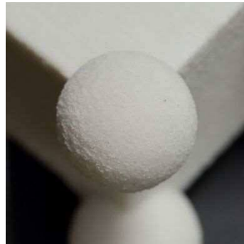
石膏粉末固着方式 積層ピッチ0.08mm
