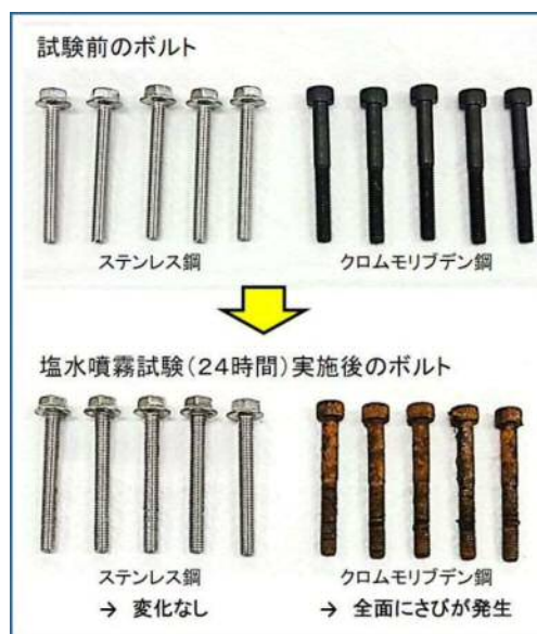
2種類のボルトによる耐食性の比較
