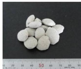
図2 人工原料の成形例
