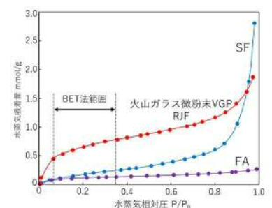
図5 RJF, SF, FAの水蒸気等温吸着曲線
