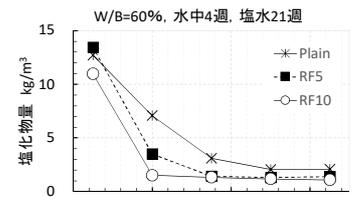
図3 コンクリートの深さ方向に対する塩化物イオンの浸透量
