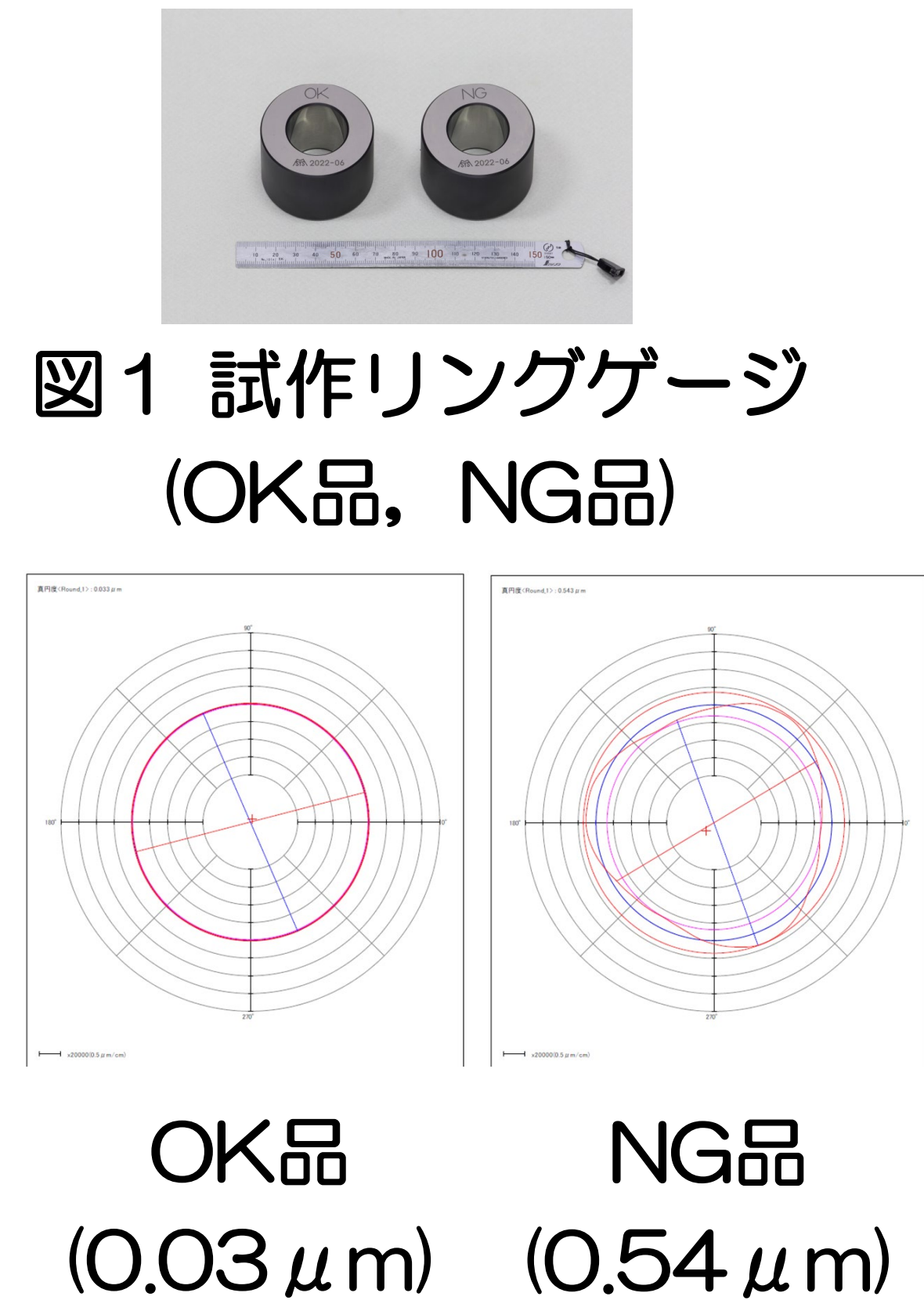
図2 真円度測定機による測定 ( )内は真円度
