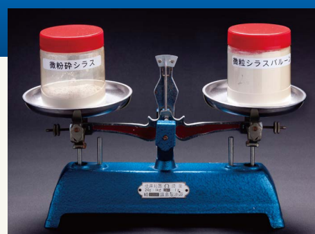
シラスを焼成してシラスバルーンにすることで、より軽く、機能性のある環境素材に生まれ変わります。
