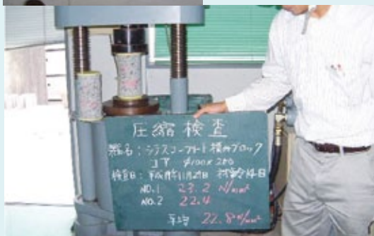
シラスブロックの圧縮強度試験
