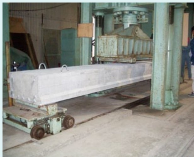
シラスコンクリート橋げたの品質試験
