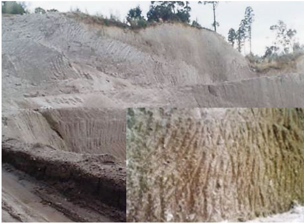
写真-1 シラス採取場と地山における固結状況
