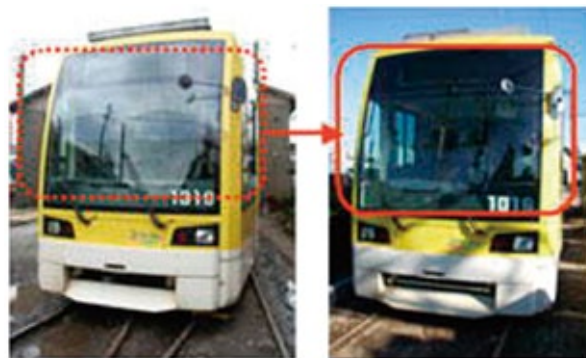
図10 シラスバルーンを配合したガラスクリーナーの洗浄効果 (左: 洗浄前 右: 洗浄後)
