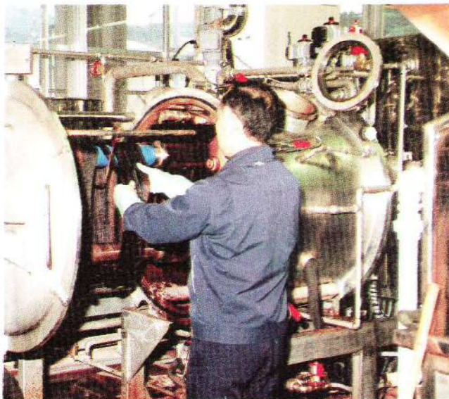
—テーチ木染めの自動染色装置— (大島紬技術指導センター)
